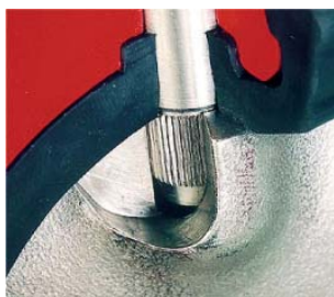
Pevné uložení hřídele v motýlu
